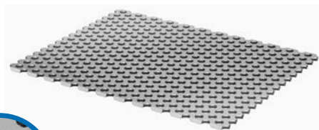
Rundlochung gestanzt z.B. Ø 1,5 mm, Teilung 2 mm in Edelstahl der Stärke 1 mm
